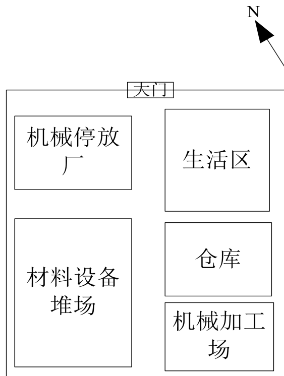
图 2.1-5 施工生产生活区平面布置图
