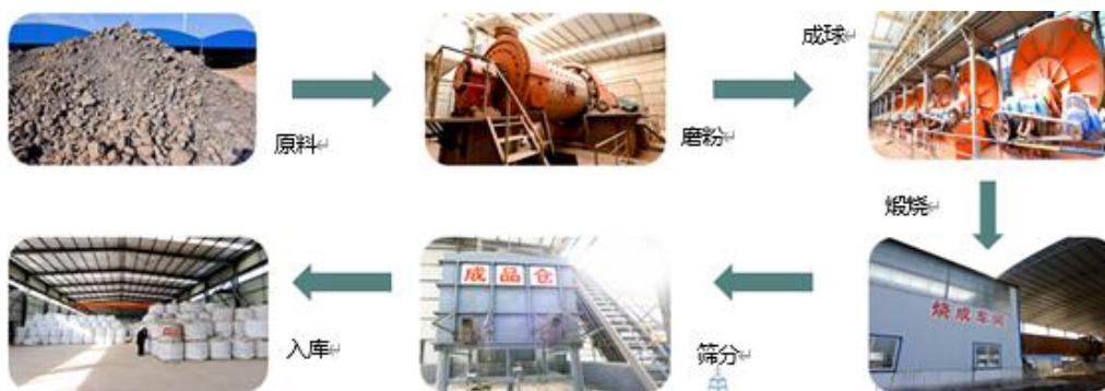
图 9 页岩气用压裂陶粒支撑剂制备工艺流程图
